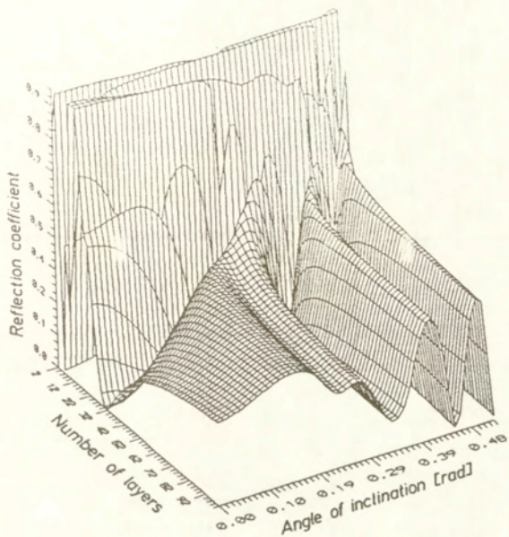
Rys.5.9 Zależność współczynnika odbicia fali poprzecznej od kąta padania \kappa^0 i gęstości uwarstwienia N ( \omega = 6800 Hz).
