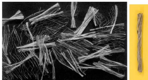
Rys. 2. Mikrowłókna polipropylenowe fibrylowane (długość ok. 12mm) oraz makrowłókna syntetyczne (skręcona wiązka długości 54mm)
