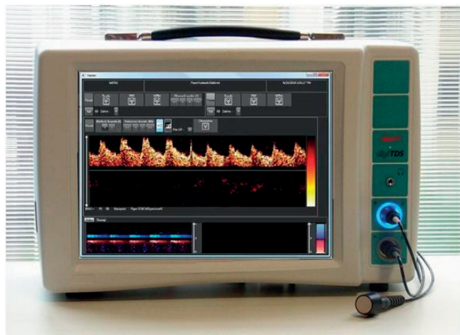
Rys. 1. Widok uruchomionego zmontowanego urządzenia wielobramkowego systemu Dopplera przezczaszkowego, gotowego do pracy, z podłączoną sondą ultradźwiękową
