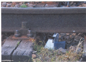
Rys. 2. Fragment toru pomiarowego (widoczny pomiarowy przetwornik laserowy) Fig. 2. Section of measured track (visible laser measuring transducer)
