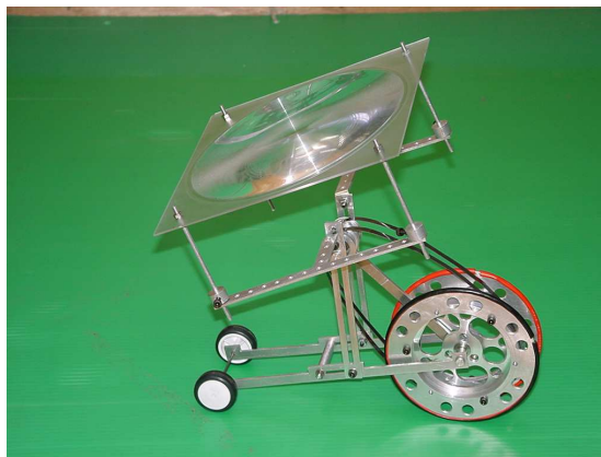
Rys. 10.5. „Solar vehicule”- ekologiczny pojazd, oparty na własnościach stopu TiNi SMA, sterowanych energią słoneczną, zaprojektowany przez studentów w ramach prac dyplomowych; AIT, Toyota-city (fotografia własna).
