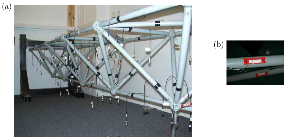
Rysunek 5.2: Stanowisko doświadczalne – trójwymiarowa kratownica. (a) widok ogólny, (b) piezo-sensor.
