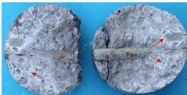
Rys. 8.2 Przykładowy odwiert z autostrady niemieckiej z widocznymi typowymi śladami ASR wokół ziaren kruszywa (białe otoczki)
