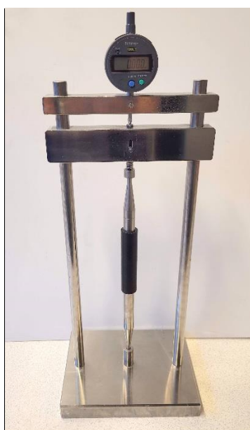
Rys. 4.3 Urządzenie do pomiaru zmian długości próbek zapraw i betonów, wraz z prętem referencyjnym wykonanym z Invaru, zaprojektowane i wykonane przez zespół z IPPT PAN
