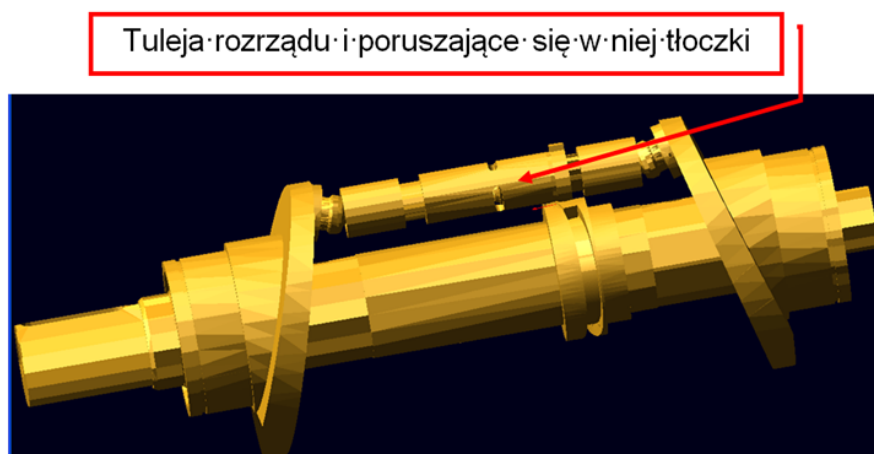
Rysunek 53 Uproszczony model kinematyczny pompy
