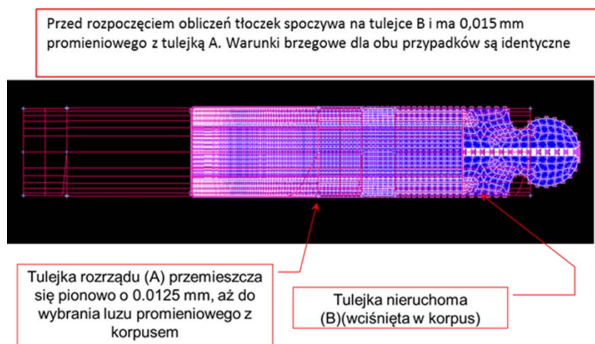
Rysunek 42 Przypadek 1 - Tłoczek wsunięty w korpus
