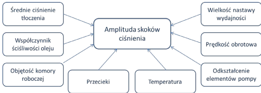
Rysunek 83 85Czynniki wpływające na amplitudę skoków ciśnienia w komorze roboczej
