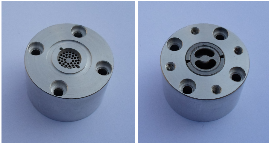
Rysunek 76: Korpus z płytkami zaworowymi oddzielonymi szczeliną, pokazany z dwóch stron
