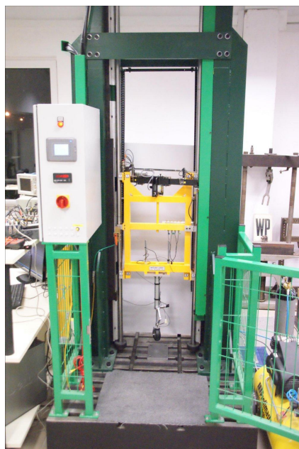
Rysunek 94: Stanowisko zrzutowe z zamontowanym na nim, badanym absorberem i schemat oczyjnikowania tego stanowiska
