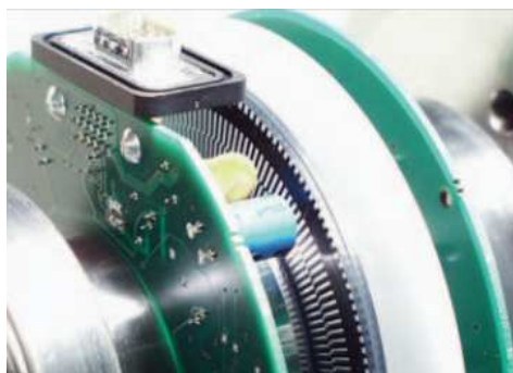
Rysunek 4.3: Dwuszczelinowa tarcza miernika momentu obrotowego DATA-FLEX 22/50.
