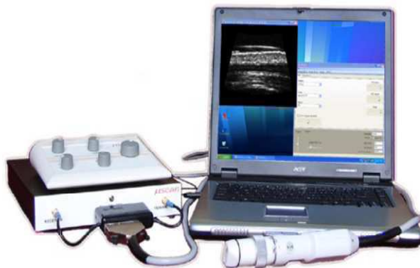
Rys. 3.2. Mikrosonograf – zaprojektowany i zbudowany w Zakładzie Ultradźwięków IPPT PAN, stosowany do obrazowania skóry.
