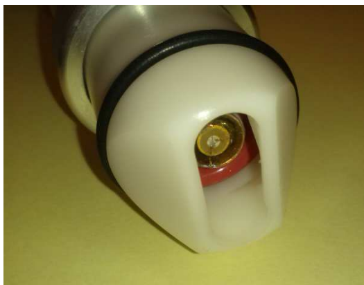
Rys. 3.8. Przetwornik zamocowany w głowicy współpracującej z mikrosonografem.
