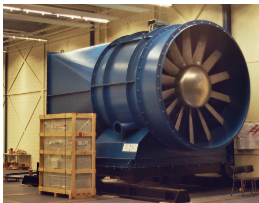
Rysunek 6.5. Turbina napędowa tunelu aerodynamicznego; średnica 3.35 m, moc silnika 500 kW
