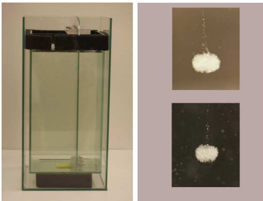
Rysunek 1.1. Zdjęcie układu doświadczalnego. Po stronie lewej pokazany został pojemnik, w którym był wykonywany eksperyment. Po prawej stronie widoczne są 2 przykładowe zdjęcia w początkowym etapie ewolucji kropli zawiesiny cząstek szklanych opadających w glicerynie.
